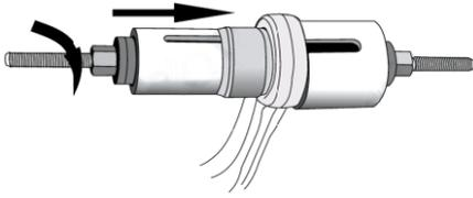
7. *La presión ejercida hará que el cojinete se coloque en el eje.*
